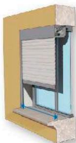
**Pose sous linteau enroulement intérieur\*.**
