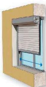
**Pose sous linteau enroulement extérieur.**
