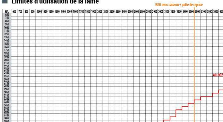
\* Pour les largeurs supérieures à 3600 mm, le BSO a des particularités de pose. Le produit n'est plus autoporté, il est nécessaire de prévoir une reprise de fixation au linteau en partie centrale
